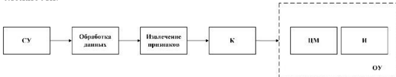
Рис. 1. Структурная схема автоматизированной системы распознавания образов электрорадиокомпонентов:
