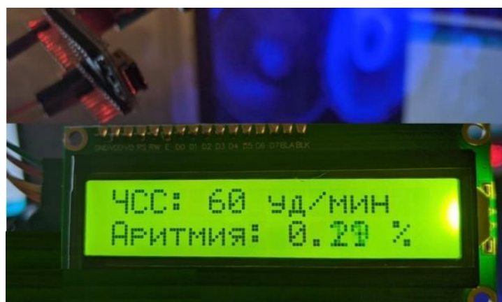
Рис. 2. Новое радиоустройство позволяет количественно определять ЧСС и процент отклонения от среднего значения ЧСС, в данном случае – 60 ударов в минуту и 29% аритмии
