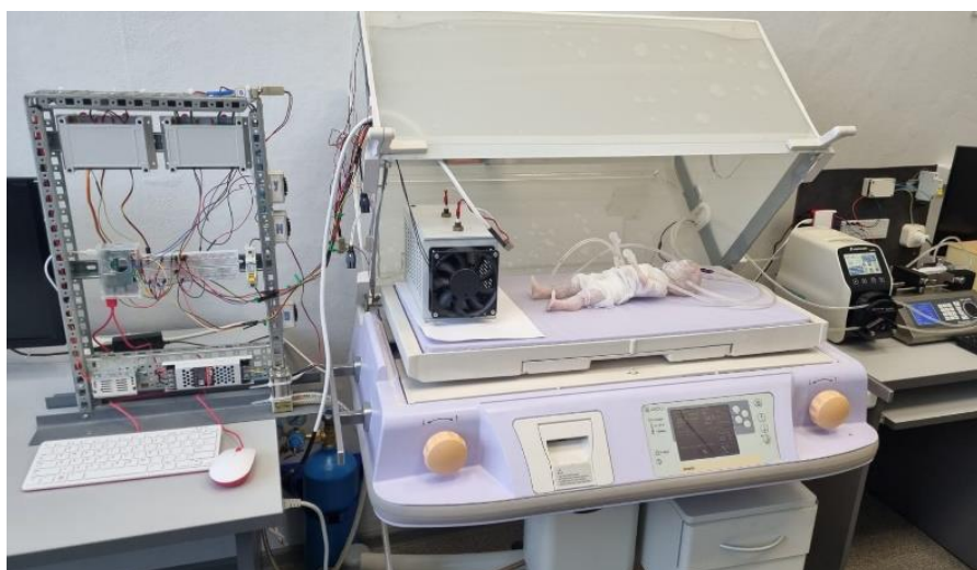
Рис. 1. Общий вид экспериментальной модели неонатального инкубатора с использованием гидродинамического фантома новорожденного
