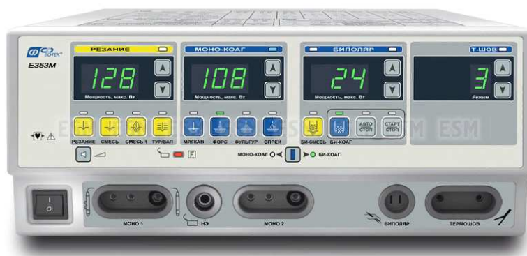
Рис. 1. Коагулятор электрохирургический высокочастотный ЭХВЧ-350-02-ФОТЕК
