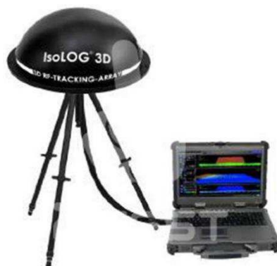
Рис. 5. Система обнаружения дронов (детектор дронов) Aaronia
