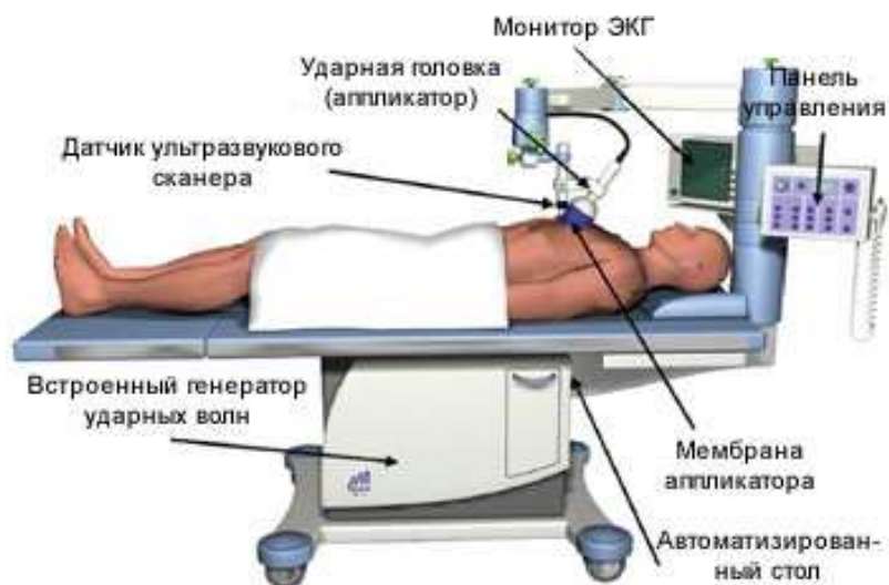
Рис. 1. Принцип работы кардиологической ударно-волновой системы
