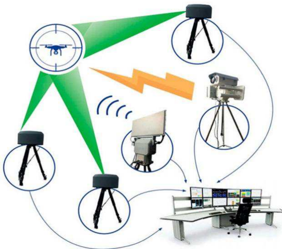
Рис. 6. Интегрированный комплекс защиты от БЛА «Стопдрон-Арсенал»
