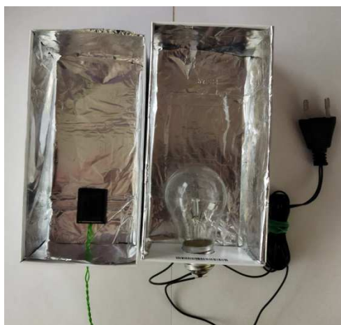
Рис. 1. Стенд для проверки СБ
